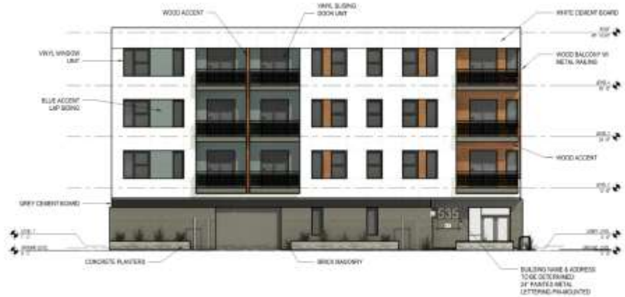
2 NORTH ELEVATION SCALE: 1/8" = 1'-0"
