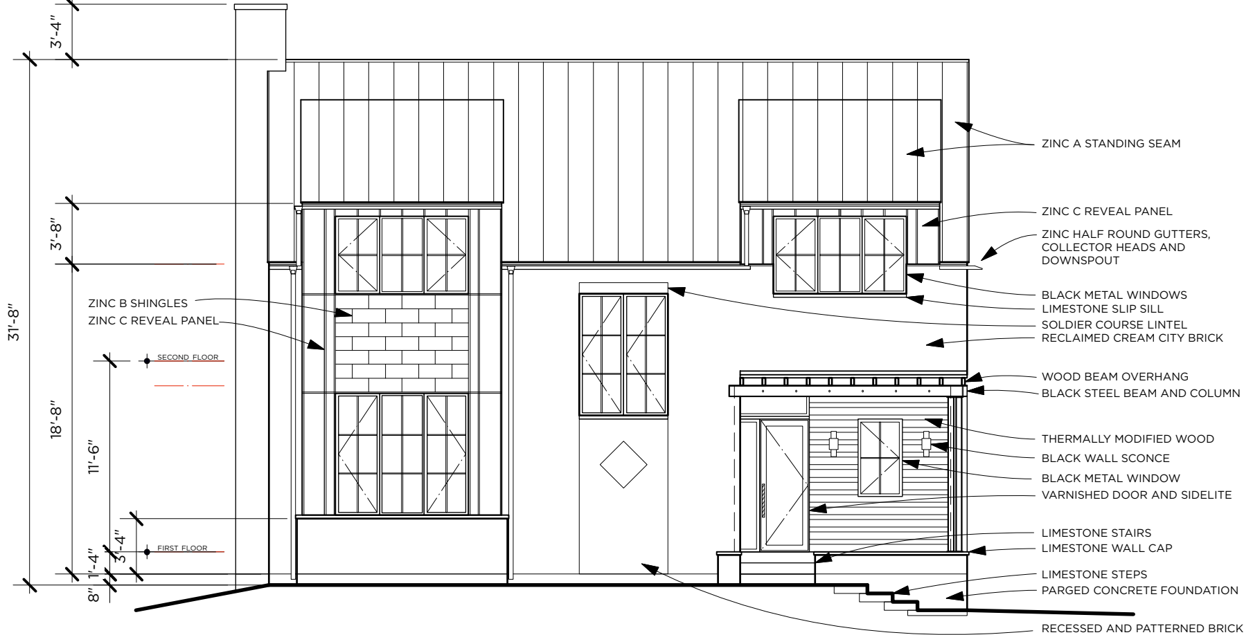
1 EAST ELEVATION SCALE: 1/8" = 1'-0"
