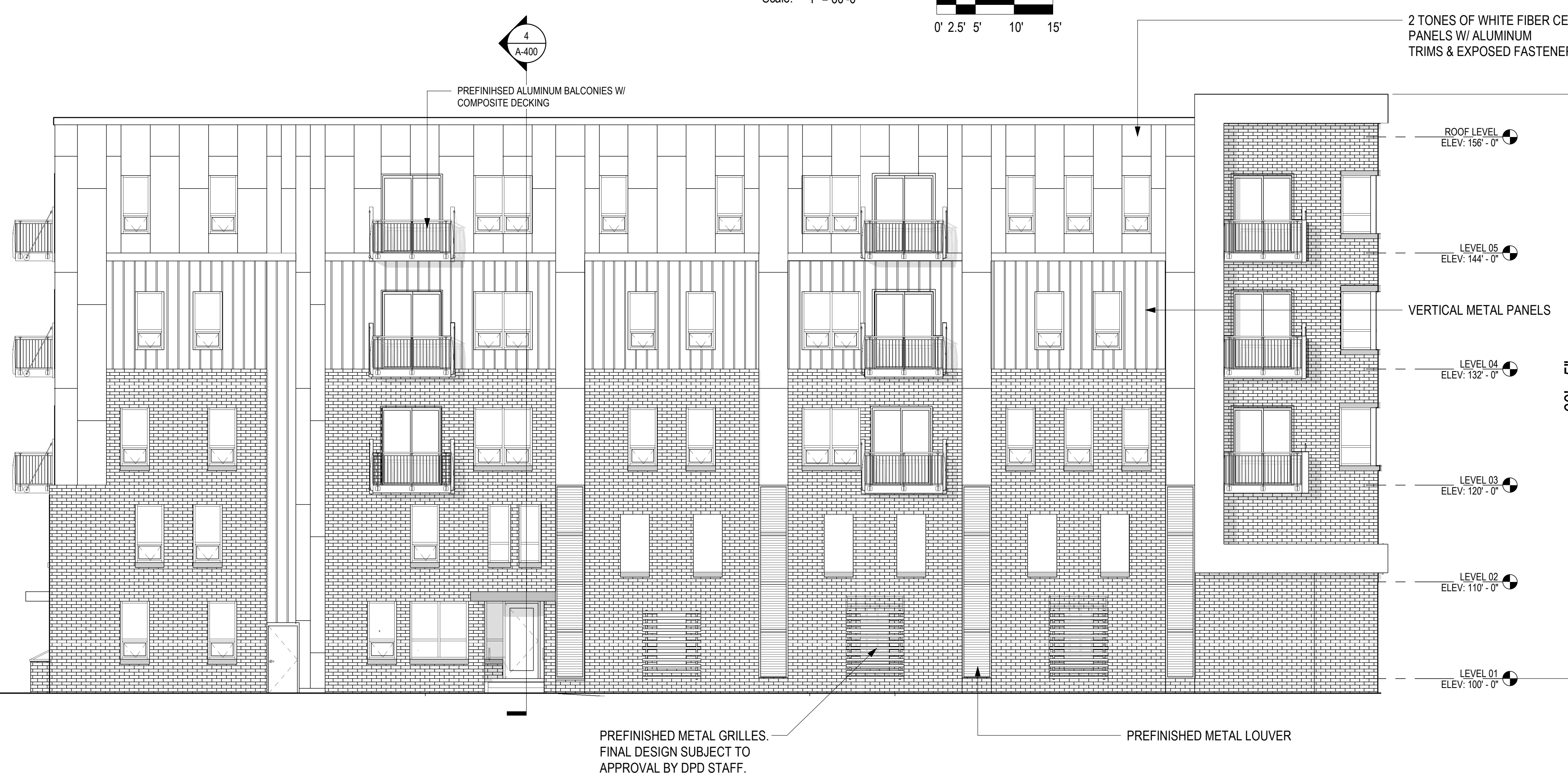
3 WEST ELEVATION Scale: 1/8" = 1'-0"
