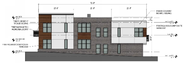
3 N. PALMER ST. ELEVATION - BUILDING A SCALE: 1/8" = 1'-0"
